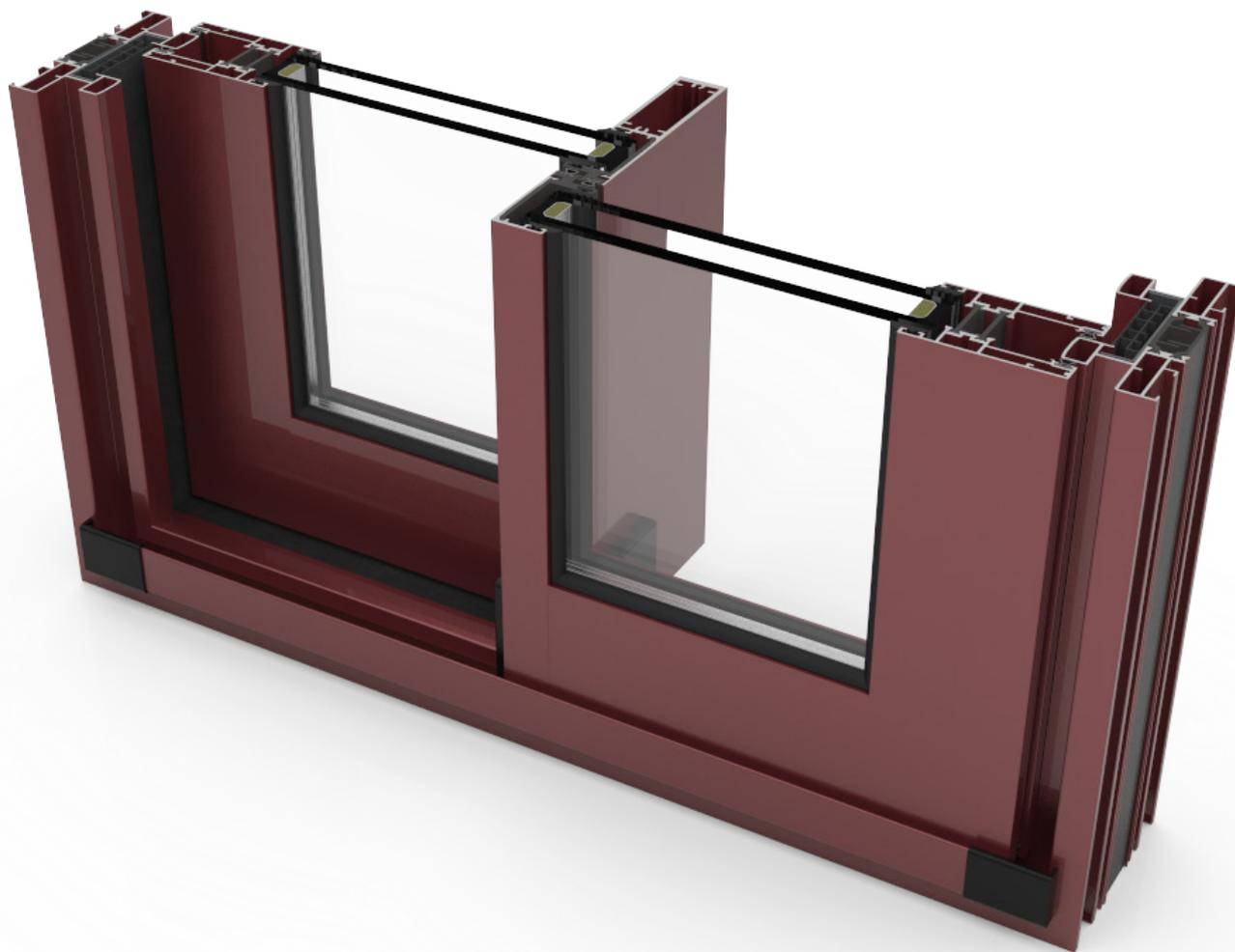
Carpintería corredera perimetral de 100mm, con rotura de puente térmico mediante pletinas de NORYL de 34mm en el cerco y 25mm en la hoja, además de la opción de cruce minimalista con 25mm de vista.
